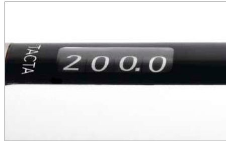
ピペットを傾けた時でも、容量が容易に読み取りできます。
